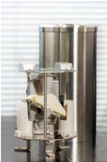
気象庁のアメダスでも使用している転倒ます型雨量計。降った雨が枙にたまるとシーソーの原理で傾いて0.5ミリずつ下に落ちる仕組みだ
